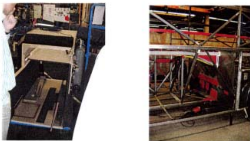
Figuur 3.14 Een unit van een slaapcabine: een houten constructie, deels voorzien van 40 mm schuim voor een betere geluidsisolatie. Rechts is een constructie van een bus te zien, waarbinnen de slaapcabine ook een plek moet krijgen
