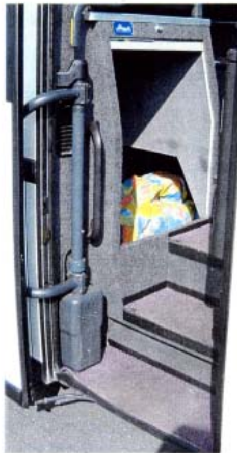
Figuur 3.9 Bij deze slaapcabine, die zich vóór de vooras van de bus bevindt, is duidelijk te zien hoe klein de slaapcabine is (na de relatief ruime ingang)
