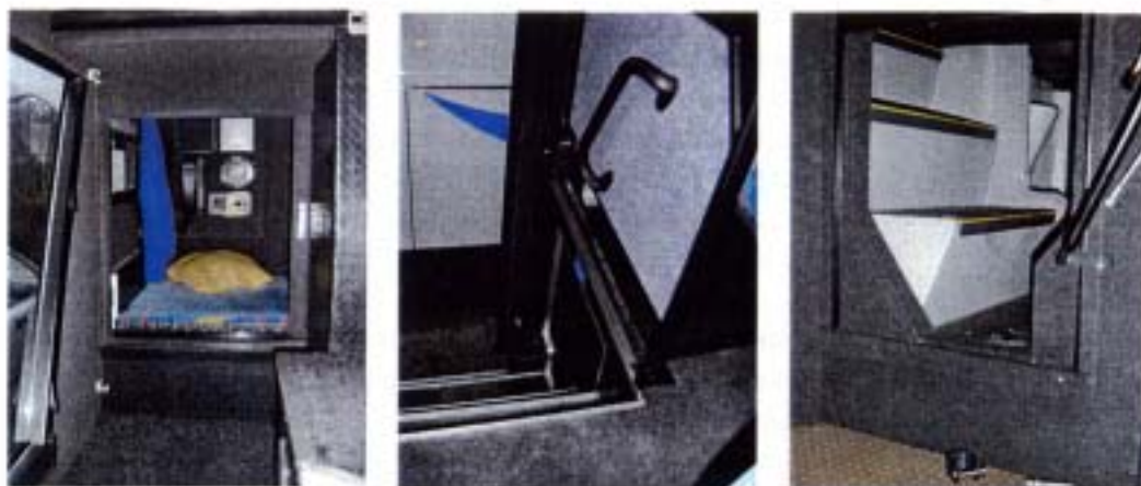
Figuur 3.7 Links de ingang van een slaapcabine boven de achteras in een dubbeldekker. Op de foto in het midden is onderaan de trap de ingang van de slaapcabine te zien. De foto rechts toont een vergelijkbare ingang, maar dan gezien vanuit de slaapcabine
